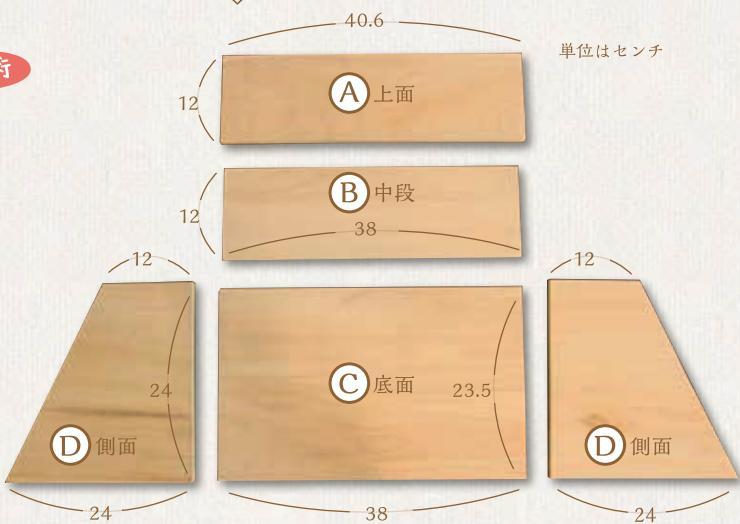
※寸法は今回用意したフォトフレームの大きさと木材の厚みで決まります。使用する材料に合わせて寸法の検討が必要です。
